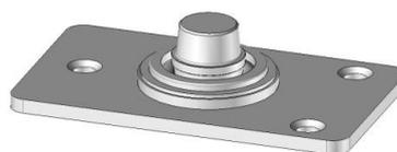
Encastrer et fixer la crapaudine dans le sol fini, avec son axe positionné à une côte A de 56mm (GRL 200 EMS) ou 66mm (LUCIFER) par rapport à l'huissérie. Pour fixer la crapaudine, utilisez les chevilles et les vis fournies dans le sachet contenant la crapaudine ou des vis béton.
